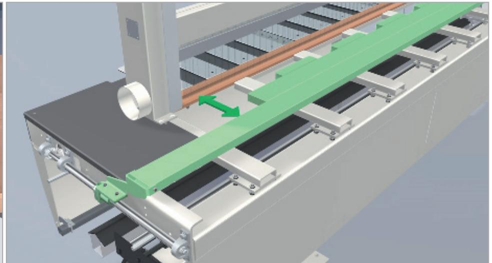
Tope de posicionamiento con una precisión de 1/10 mm
