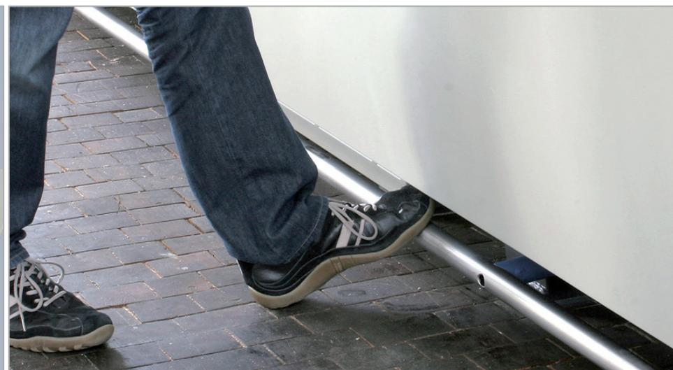
Activación del corte mediante pedal
