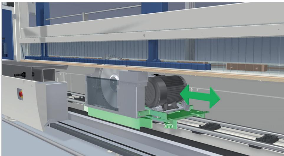
Guiado perfecto del carro mediante rodillos laterales
